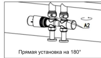
Затяните соединительный колпачок A2 с помощью инструмента T1 или T3
